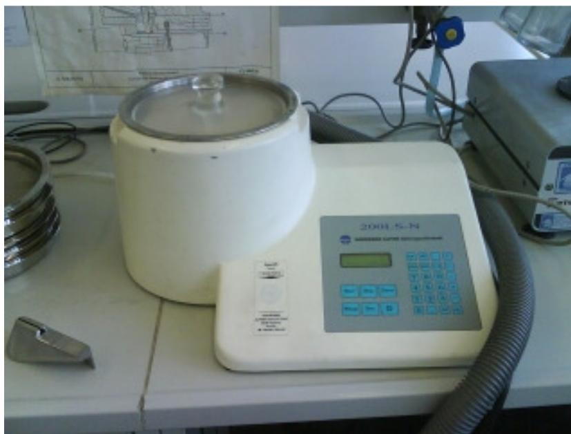
Abbildung 4 Luftstrahlsieb im Betrieb
