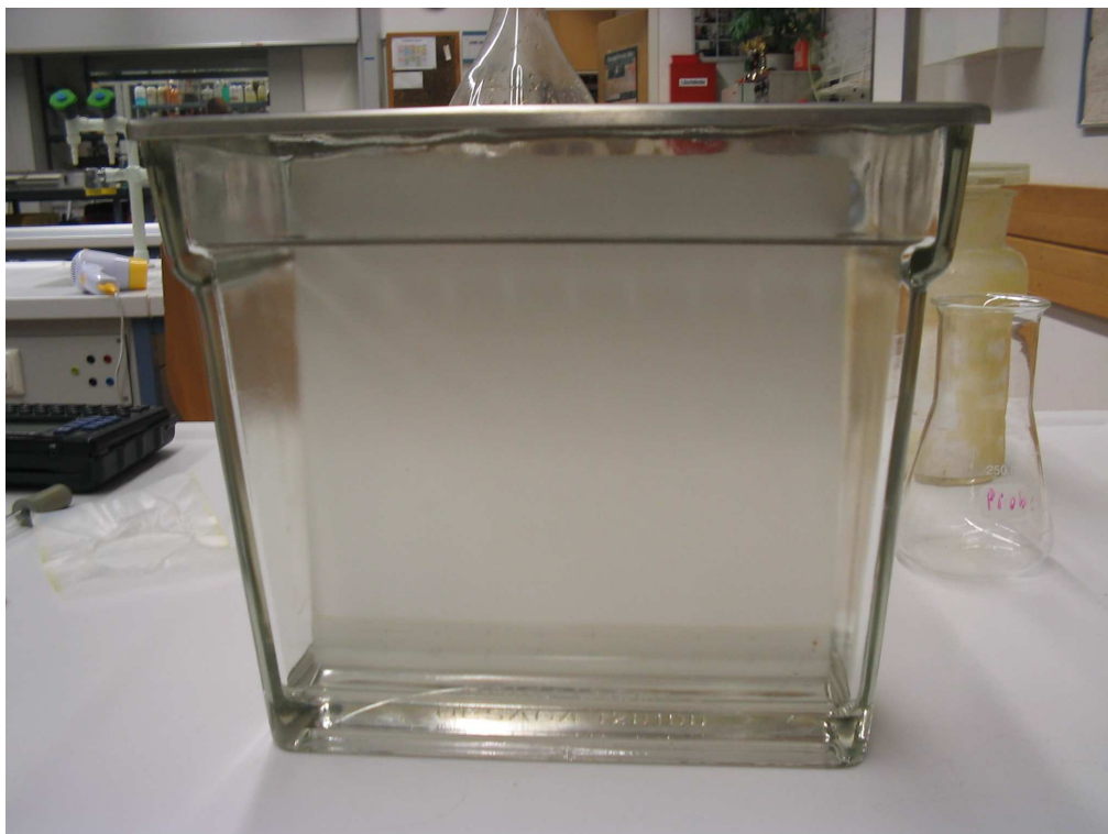
Abbildung 15 DC-Platte im Chromatographietank
